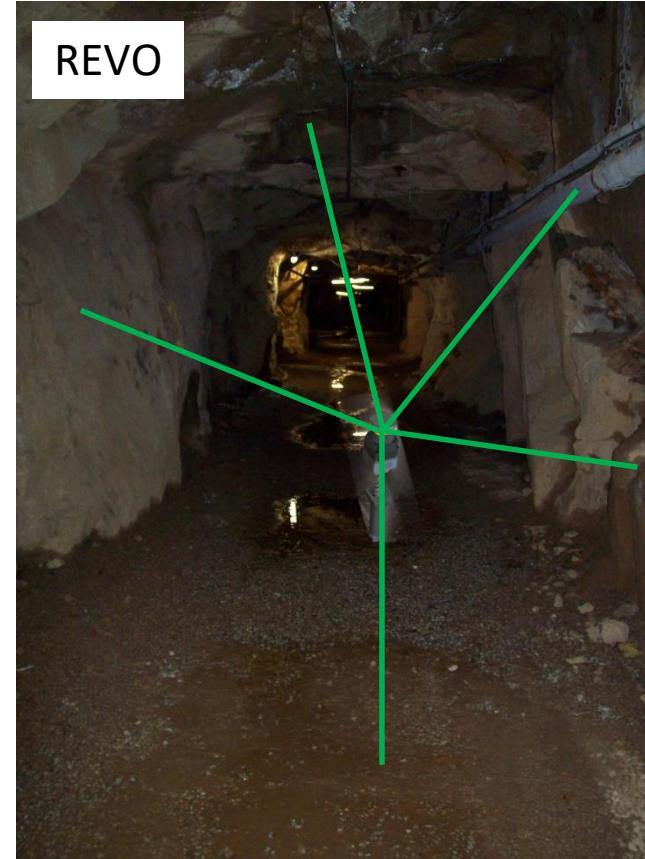
La geometría de las características del entorno tiene una gran incidencia en el resultado de la solución. El entorno óptimo para el sistema REVO es un área donde hay características que rodean el escáner y que miran hacia todas las direcciones.
